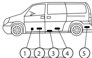
В основном обогреватель устанавливается в пассажирском (1-4) или багажном (5) отделении автомобиля. Если его невозможно установить, закрепите обогреватель под днищем автомобиля, но опасайтесь брызг.
