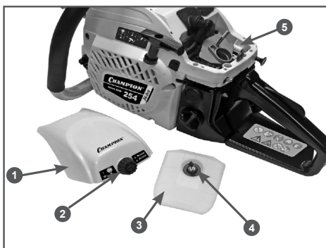
Рис. 21 Обслуживание воздушного фильтра
