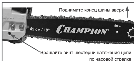
Рис. 5 Регулировка натяжения цепи
