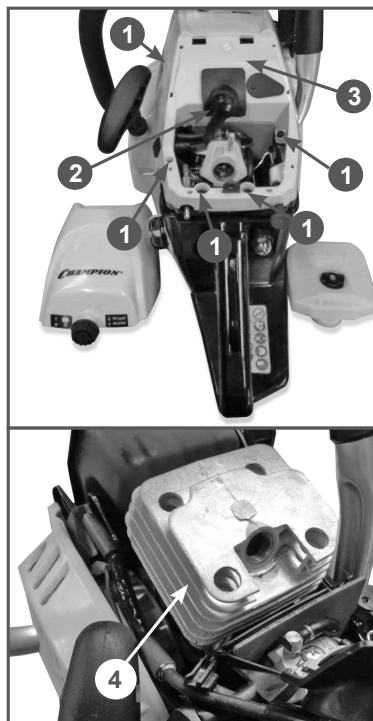
Рис. 23 Очистка охлаждающих ребер цилиндра
