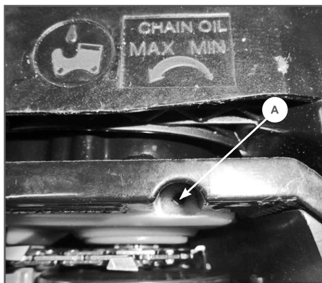
Рис. 13 Положение регулировочного винта подачи масла
