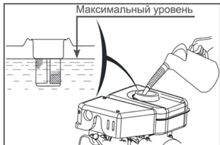
Рис. 2 Максимальный уровень топлива в топливном баке
